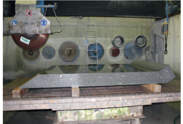
Eine der sechs Dachscheiben: Der innenliegende Übergang ist vom Steinmetzen leicht abgerundet worden
