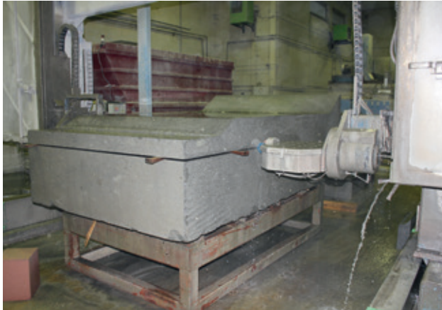
Nach detailgenauer Planung am Computer wurden die Dach- und Wandelemente im Werk aus drei großen Blöcken zugeschnitten
